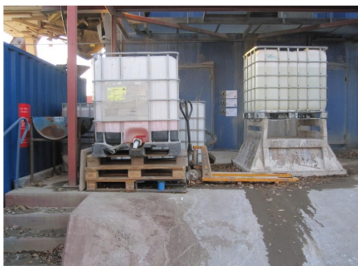
Bild 7. Skanska Betongs kemikalier som är stående utomhus. Formoljan Sika Separol MB-507, som den ena behållaren innehåller, är speciellt olämplig att sprida till miljön. Den andra behållaren innehåller bindemedlet Sika Retarder vilket är mer ofarligt för miljön.
