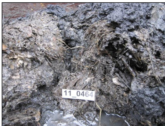
T.v. Centrala skredområdet med provtagningsplats 11_0464. T.h. prov av skredmassor med sopor.
