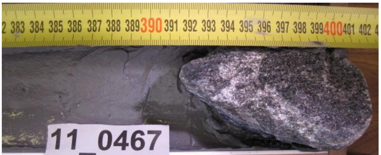
Stenen som satt fast i borrhärlspetsen och hindrade ytterligare penetrering ned i botten.
