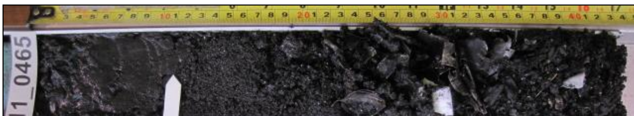
Sedimentkärna utvisande stratigrafin. Pilen markerar övergången mellan lergyttjan och mellansanden/slaggen som överlagrar soporna.
