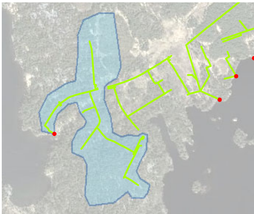
Figur 9.1.2. Exempel på utsläppspunkt (röd) med tillhörande tillrinningsområde (blått). Notera förändringen på dagvattennätet (grönt) jämfört med figur 9.1.1.
