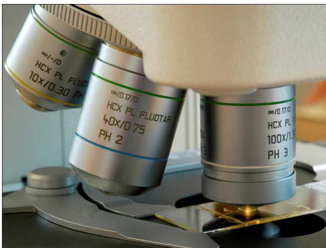
Figur 1. Kiselalgsanalys görs i ljusmikroskop i minst 1000 gånger förstoring med oljeimmersionsobjektiv. Mikroskopet ska helst vara utrustat med interferenskontrast, vilket gör att man kan se mycket små former tydligare än med andra tekniker, © Medins Biologi AB
