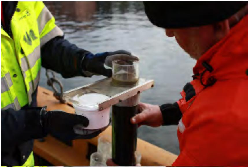
Figur 3. Snittning och provuttag av de översta 2 centimetrarna.
