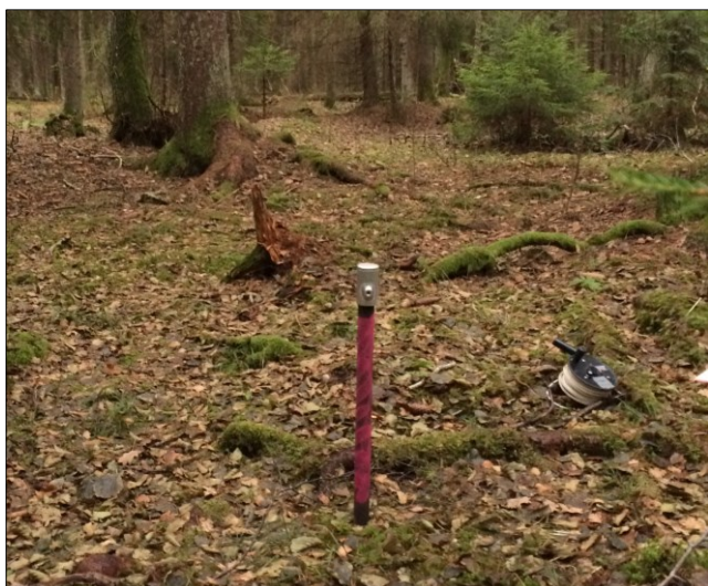
Figur 5. T.v. exempel på typiskt observationsrör. T.h. en nivålogger av typen TD-DiverTM, (www.vanessen.com).
